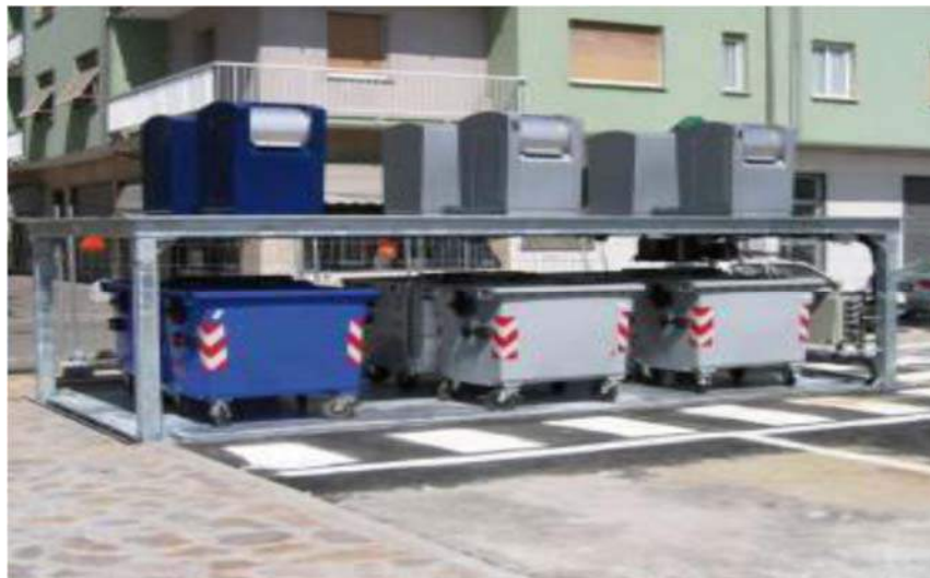
Εικόνα 7-5: Σύστημα βυθιζόμενων κάδων
