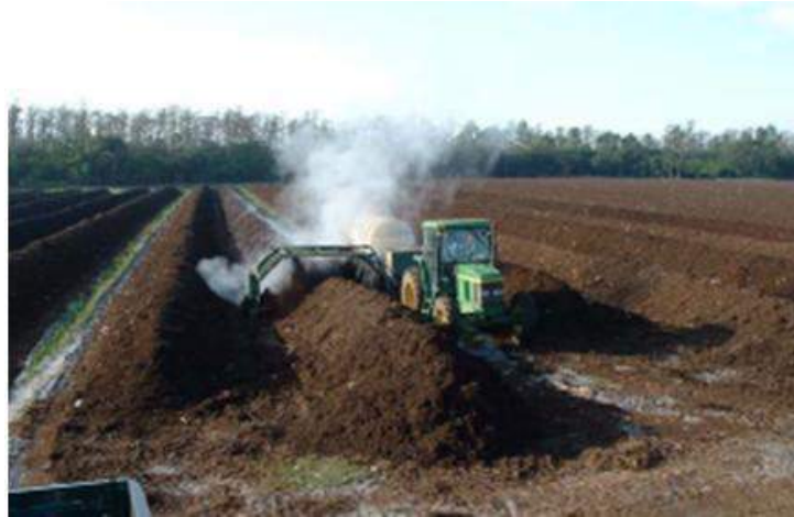
Εικόνα 7-17: Σύστημα αναστρεφόμενων σειραδιών με αυτοκινούμενο αναστροφέα.
