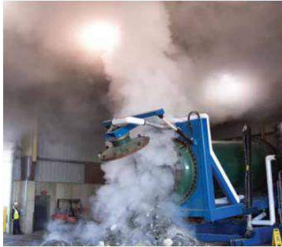
Εικόνα 7-37: Θάλαμος θερμικής επεξεργασίας.
