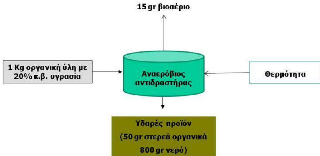
Εικόνα 7-24: Ενδεικτικό ισοζύγιο μάζας αναερόβιας χώνευσης ΑΣΑ (Πηγή: DEFRA, 2005a).
