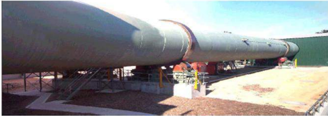
Εικόνα 7-16: Σύστημα κομποστοποίησης σε περιστρεφόμενο τύμπανο της εταιρίας Bedminster (χρόνος παραμονής 3 ημέρες).
