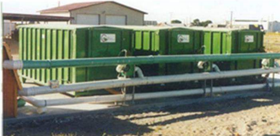
Εικόνα 7-12: Σύστημα κομποστοποίησης σε κιβώτια.
