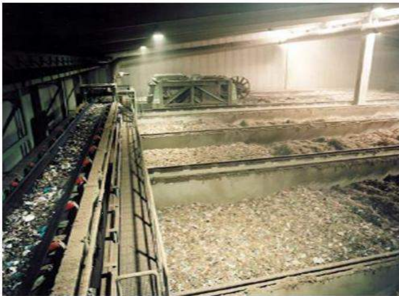
Εικόνα 7-14: Σύστημα κομποστοποίησης σε δεξαμενές.
