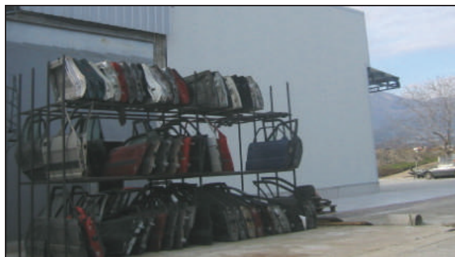
Φωτ. 13 Αποθήκευση μερών φανοποιίας (μη ρυπασμένα) σε ράφια χωρίς επικάλυψη
