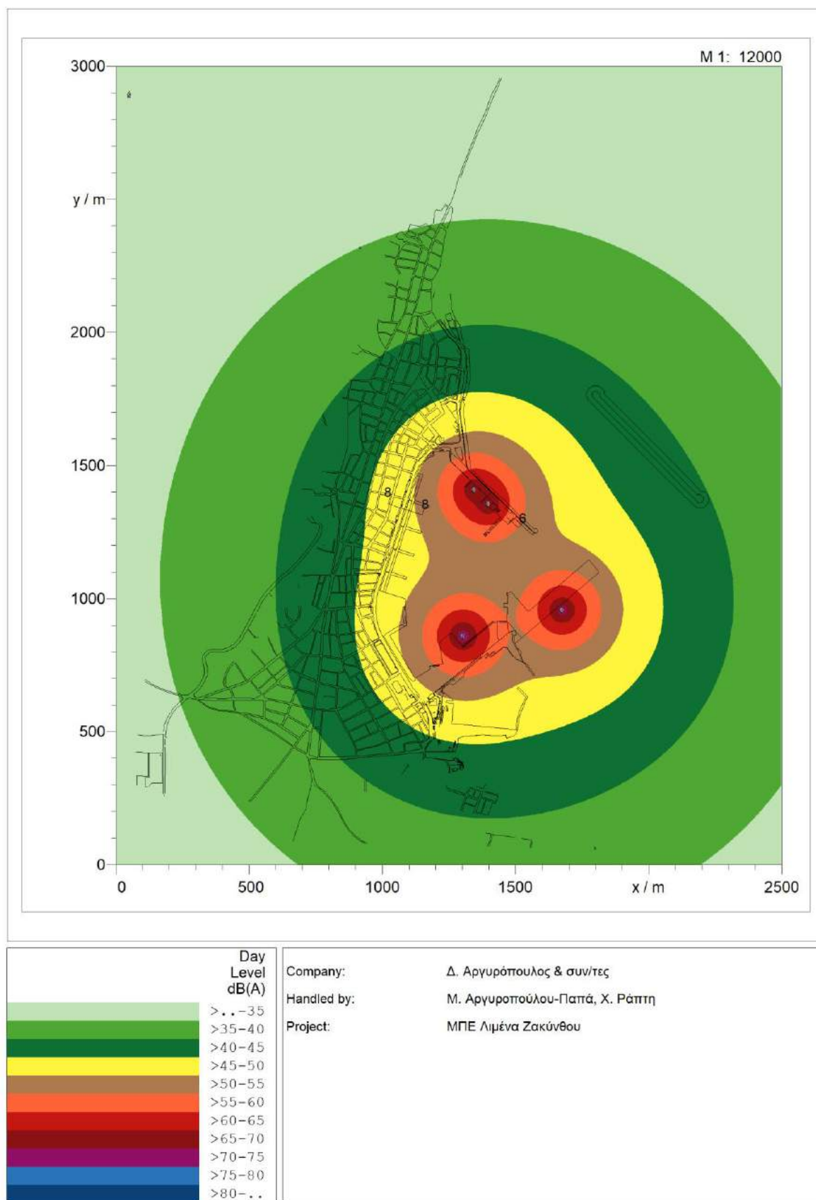
Σχήμα 3.5.2-1 Ισοθορυβικές καμπύλες από τη συνολική λειτουργία των πλοίων εντός του λιμένα της Ζακύνθου
