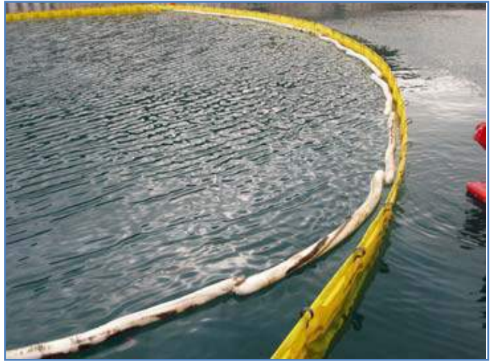
Ενδεικτικού τύπου Απορροφητικό φράγμα
