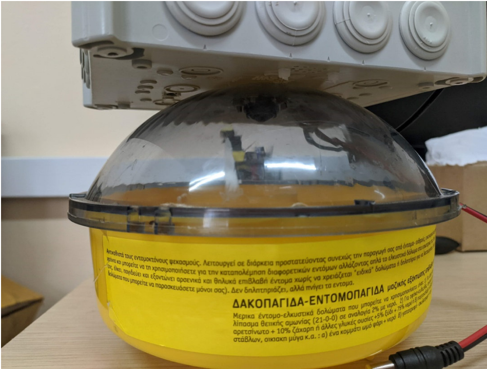
Εικόνα 1. Το σύστημα του Ελαιοπαρατηρητή όπως έχει προσαρμοστεί στο επάνω μέρος της κλασικής δακοπαγίδας
