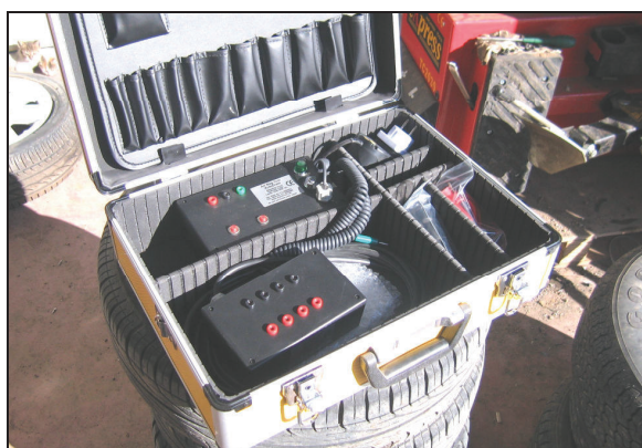
Φωτ. 8 Εξοπλισμός εξουδετέρωσης αερόσακκων σκραπ (παραχώρηση: Ζησιμάτος Σταύρος & Σία ΟΕ)
