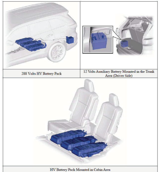
Σχήμα 11 Η θέση της μπαταρίας Ni-MH/280 V σε υβριδικό Highlander της TOYOTA [12]
