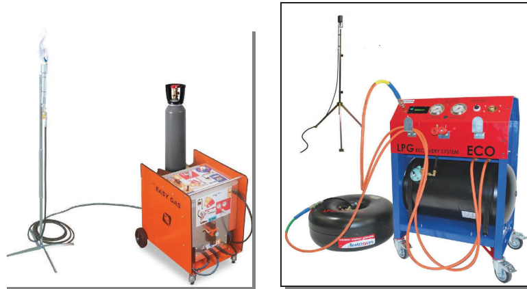
Φωτ. 13 Αντλίες αναρρόφησης κι επαναπλήρωσης LPG των οίκων Iris-Mec (It) & SEDA (A)
