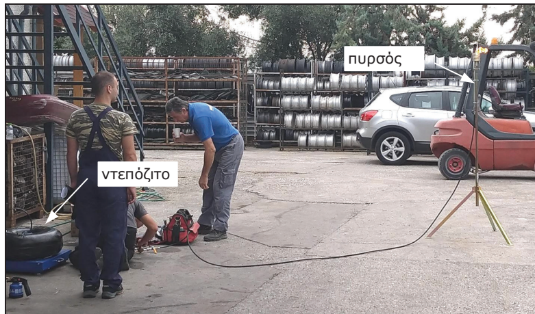
Φωτ. 14 Ελεγχόμενη καύση LPG κατευθείαν από το ντεπόζιτο
