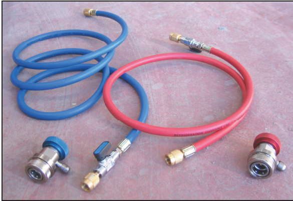
Φωτ. 9 Σωλήνες αναρρόφησης ψυκτικού A/C και «αντάπτορες»
