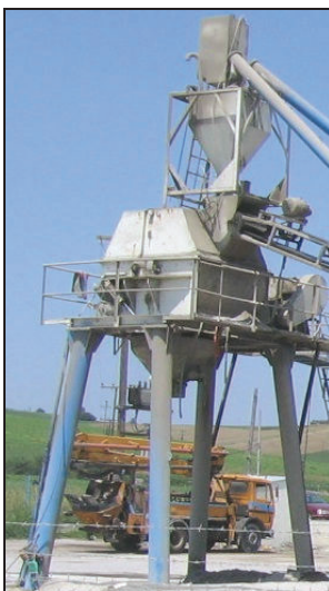
Φωτ. 26 Εξοπλισμός παραγωγής σκυροδέματος
