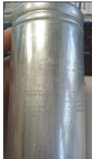
Φωτ. 27 Πυκνωτής ισχύος χωρίς PCBs
