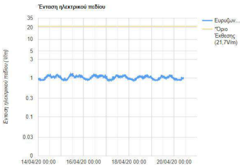
Σχήμα 8.12-1 Μετρούμενη ένταση ηλεκτρικού πεδίου στην πόλη της Ζακύνθου κατά το διάστημα από 14-04-2020 μέχρι 20-04-2020
