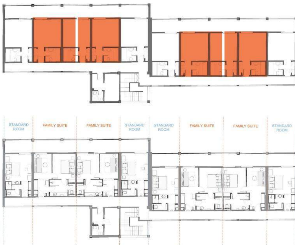
Σχήμα 6.4-3 Συνένωση δωματίων 21 τ.μ. με στόχο τη δημιουργία νέων τύπων 32 τ.μ.
