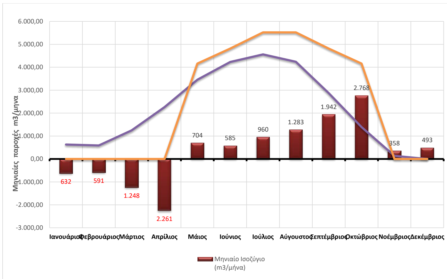
Σχήμα 6.6-1 Μηνιαίο αρδευτικό ισοζύγιο, απαιτούμενες αρδευτικές ανάγκες και διαθέσιμες παροχές επεξεργασμένων της τουριστικής ανάπτυξης.
