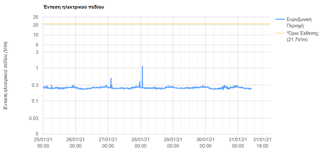
Σχήμα 8.12-3 Μετρούμενη ένταση ηλεκτρικού πεδίου στο Γυμνάσιο Λιαπάδων κατά το διάστημα από 25-1-2021 μέχρι 31-1-2021
