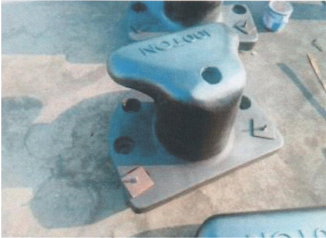
Εικόνα 3. Τυπική χαλύβδινη δέστρα με ελκτική ικανότητα 100 tn.
