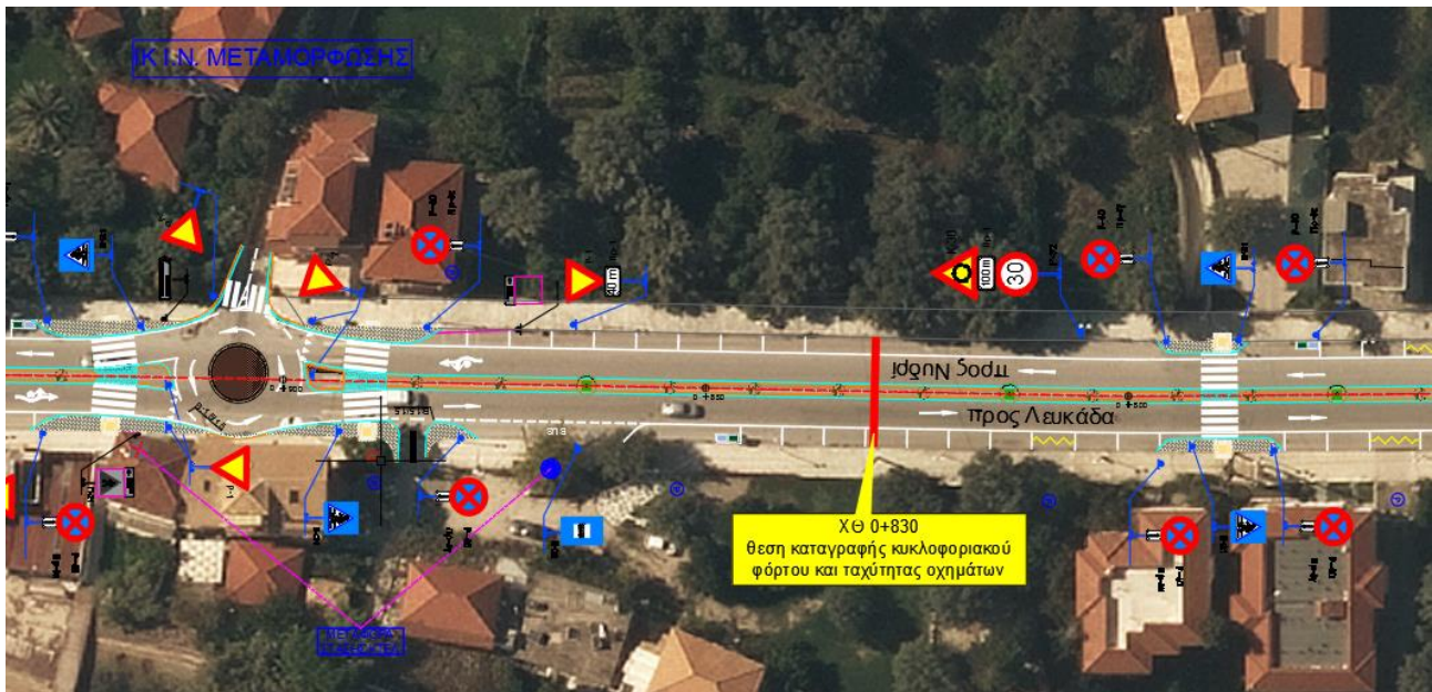
ΧΘ 0+830 – Θέση που πραγματοποιήθηκαν οι επιτόπου μετρήσεις και καταγραφές τις κυκλοφορίας.
