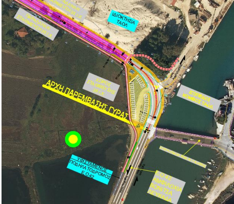
Εικόνα 6-2: Άποψη της αποκατάστασης – ανάπλασης στην αρχή του έργου
