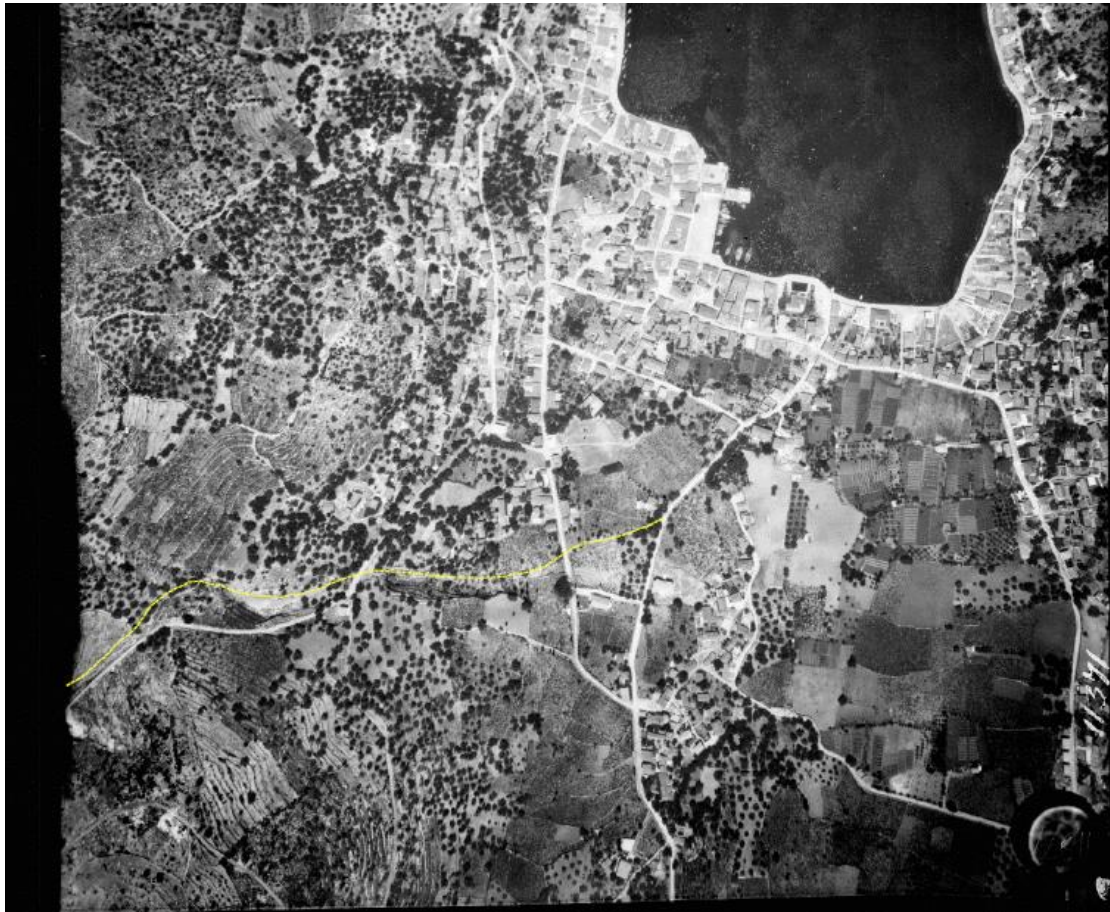
Εικόνα 57. Διερεύνηση ιστορικής κοίτης ρεμάτων Περαχωρίου (Βαθύ - 2) και Παλιοπόταμου (Βαθύ – 3) (αεροφωτογραφία φορέα Ελληνικό Κτηματολόγιο W BW 34 911371 έτους 1934)
