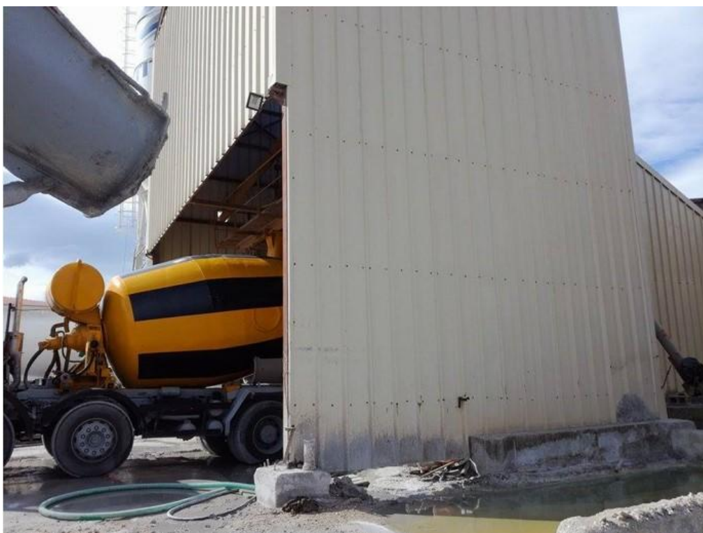
Φ10. ΥΠΑΙΘΡΙΑ ΔΕΞΑΜΕΝΗ ΔΙΑΘΕΣΗΣ ΤΩΝ ΥΓΡΩΝ ΑΠΟ ΤΗΝ ΕΚΠΛΥΣΗ ΤΟΥ ΜΙΞΕΡ ΚΑΙ ΤΩΝ ΔΕΞΑΜΕΝΩΝ ΣΚΥΡΟΔΕΜΑΤΟΣ ΤΩΝ ΟΧΗΜΑΤΩΝ
