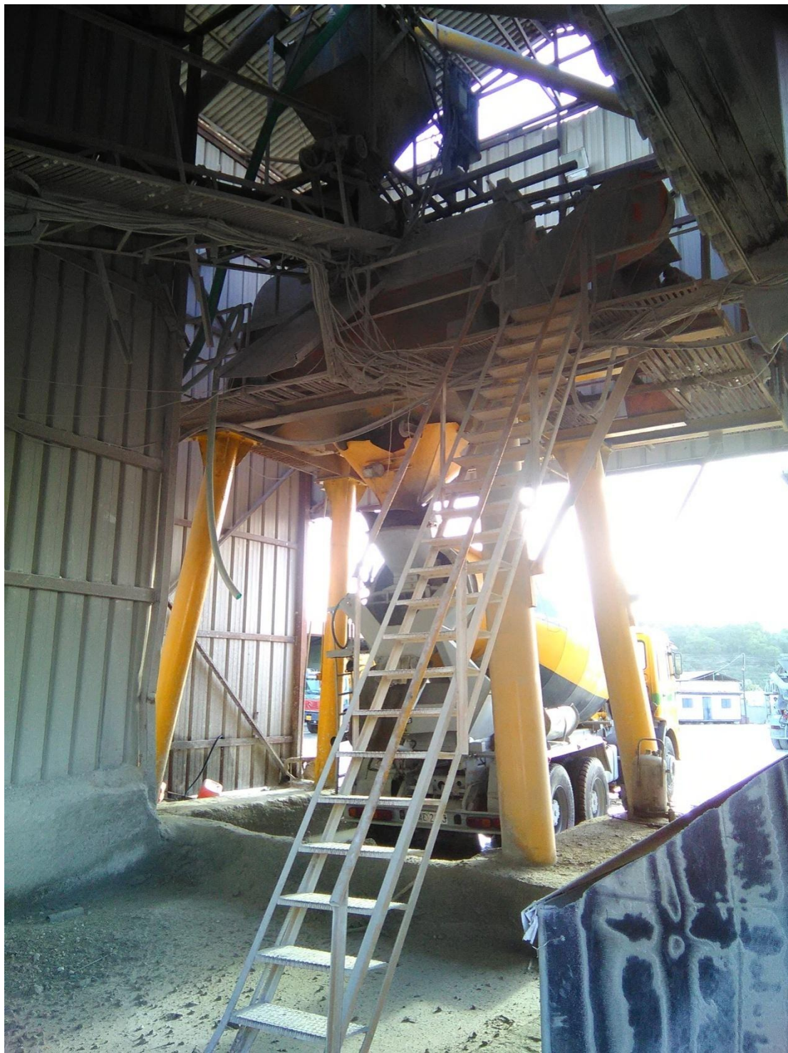
Φ3. ΣΤΕΓΑΣΜΕΝΑ ΜΙΞΕΡ ΠΑΡΑΓΩΓΗΣ - ΖΥΓΙΣΤΙΚΟ ΤΣΙΜΕΝΤΟΥ - ΚΕΝΤΡΙΚΗ ΤΑΙΝΙΑ ΚΑΙ ΤΟΙΧΙΟ ΠΕΡΙΟΡΙΣΜΟΥ ΡΥΠΑΝΣΗΣ ΟΤΑΝ ΦΟΡΤΩΝΟΥΝ ΟΙ ΒΑΡΕΛΛΕΣ
