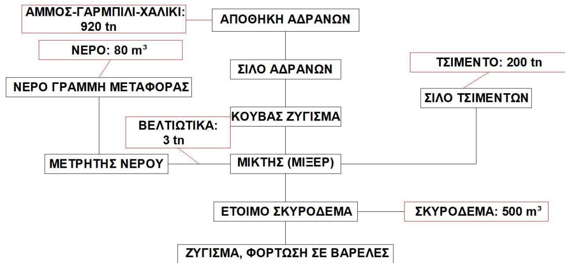
Σχήμα 2: Διάγραμμα ροής-μάζας με ενδεικτικές εισροές εισερχόμενων προϊόντων και ενδεικτικές εκροές εξερχόμενου προϊόντος της Μονάδας Παραγωγής Σκυροδέματος (για την κατά μέγιστο παραγωγή 500 m 3 σκυροδέματος)
