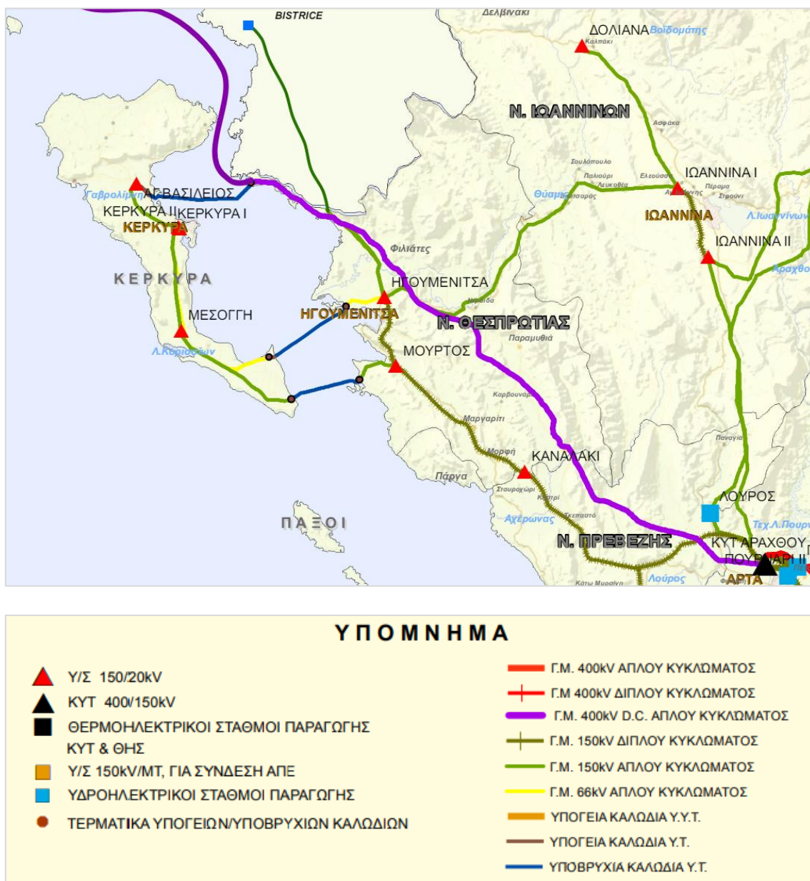
Σχήμα 8.9-2: Γραμμές μεταφοράς ηλεκτρικής ενέργειας
