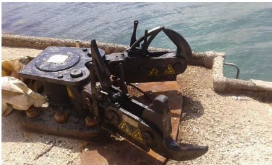
Εικόνα 6.2-3: Δέστρα επί της προβλήτας με διπλό άγκιστρο ταχείας απασφάλισης
